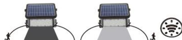
Wenn die Bewegung erkannt wird (bis zu 8 m), leuchtet der Scheinwerfer automatisch mit voller (100%) Leistung auf, und nach 20 Sekunden ohne Bewegungserkennung schaltet der Lichtleistungswert auf 3% des Maximalwerts.
