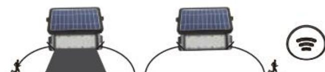
Wenn Bewegung erkannt wird (bis zu 8 m), leuchtet das Flutlicht automatisch mit voller Leistung (100%) und schaltet dann die Lichtquelle nach 30 Sekunden ohne Bewegungserkennung aus.
