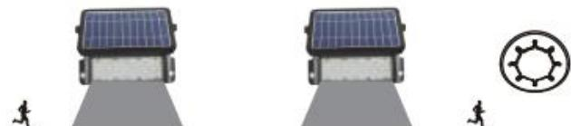
Nach der Aktivierung leuchtet der Scheinwerfer automatisch für die gesamte Dauer auf 20% seiner maximalen Leistung.
